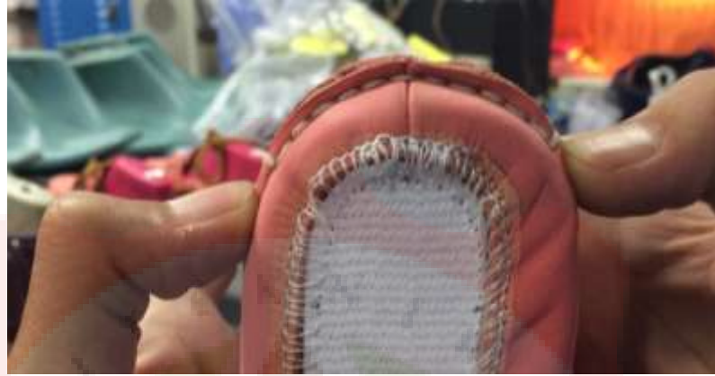
Gambar 23. Bagian counter miring akibat jahit strobrel kendur
