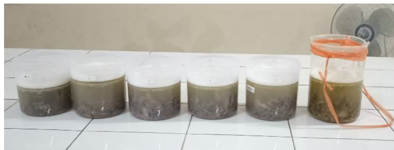
Gambar : Limbah fleshing yang telah direbus dimasukkan ke wadah plastik kapasitas dua liter.
