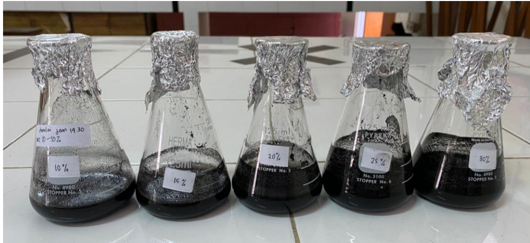
Gambar4.2. Karbon direndam dalam larutan KOH dengan variasi konsentrasi KOH
